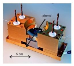
写真:開発された「photon box」光共振器. 中央が超伝導ミラーで,これと同じものが上側にも付く. arXiv:quant-ph/0612138v1 より転載.
