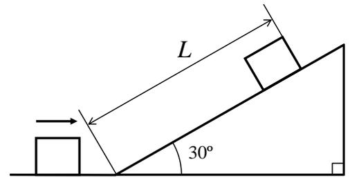
(1) 斜面方向に  $x$  軸を取り、運動方程式を立てなさい(10).
