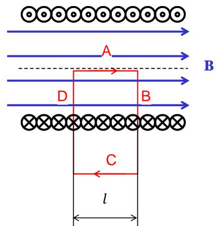
Q2: 円形のトロイダルコイルがある。トロイダルコイルとは、ドーナツ状の芯に導線を密に巻いたものである。導線の全巻き数を $N$ とする。ここに電流 $I$ を流した時のコイル内部の磁場を求めよ。右図を使い、計算過程を文章で説明すること(20)
