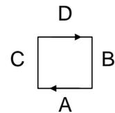
対称性の議論から磁場は軸方向で、一方周回路を囲む電流はゼロだから、経路 A, D の磁場は等しい。すなわち、ソレノイド外部の磁場はどこでも一樣と分かる。無限遠の磁場はゼロだから、ソレノイド外部の磁場はどこでもゼロ。
